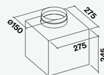
Moteur déporté sous combles Induction 1300 m<sup>3</sup>/h
