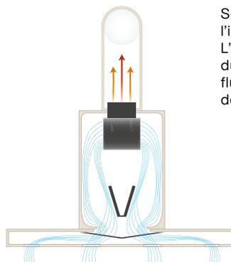
Schéma de flux à l'intérieur d'une hotte NRS. L'insonorisation de la chambre du moteur et la conception des flux d'air minimisent le bruit de fonctionnement.
