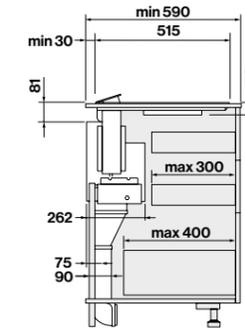
Vista lateral con motor en posición trasera (instalación en la isla)
