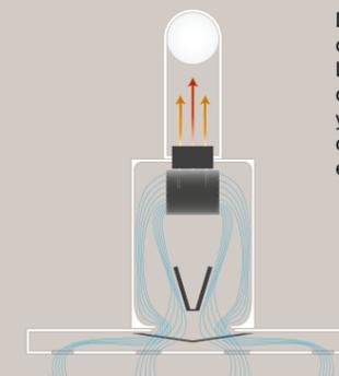
Diagrama de flujo interno de una campana NRS. La insonorización de la cámara del motor y el estudio de los flujos de aire reducen al mínimo el ruido de funcionamiento.
