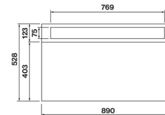
Vista lateral con el motor en posición frontal (instalación en pared).
