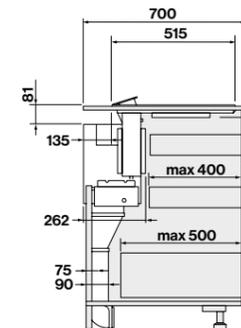
Vista lateral con motor en posición delantera con Silence Kit KACL.1026
