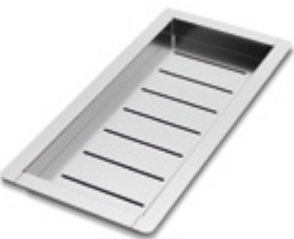
INOX inzetschaal AISI 304 18/10 INOX inzetschaal Dikte 1 mm Buiten afmeting: 200 x 440 mm Binnen afmeting: 155 x 390 mm Diepte: 30 mm
