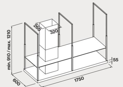
Absaugbereich 90 cm unter dem Schacht
