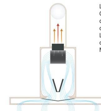
Luftstroms in einem NRS Gerät. Die Schalldämmung des Motorblocks und die Optimierung des Luftstromweges reduziert das Betriebsgeräusch auf ein Minimum.
