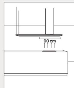
Absaugbereich 90 cm unter dem Schacht
