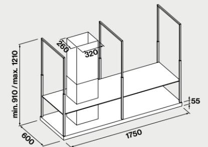
Absaugbereich 90 cm unter dem Schacht
