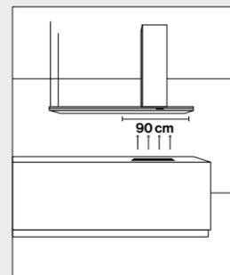
Absaugbereich 90 cm unter dem Schacht
